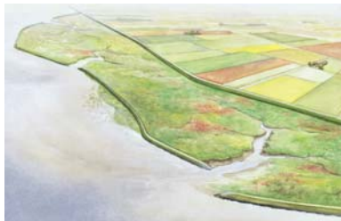
Schorbuffers: herstel van schor door landinwaartse verlegging van de zeedijk
